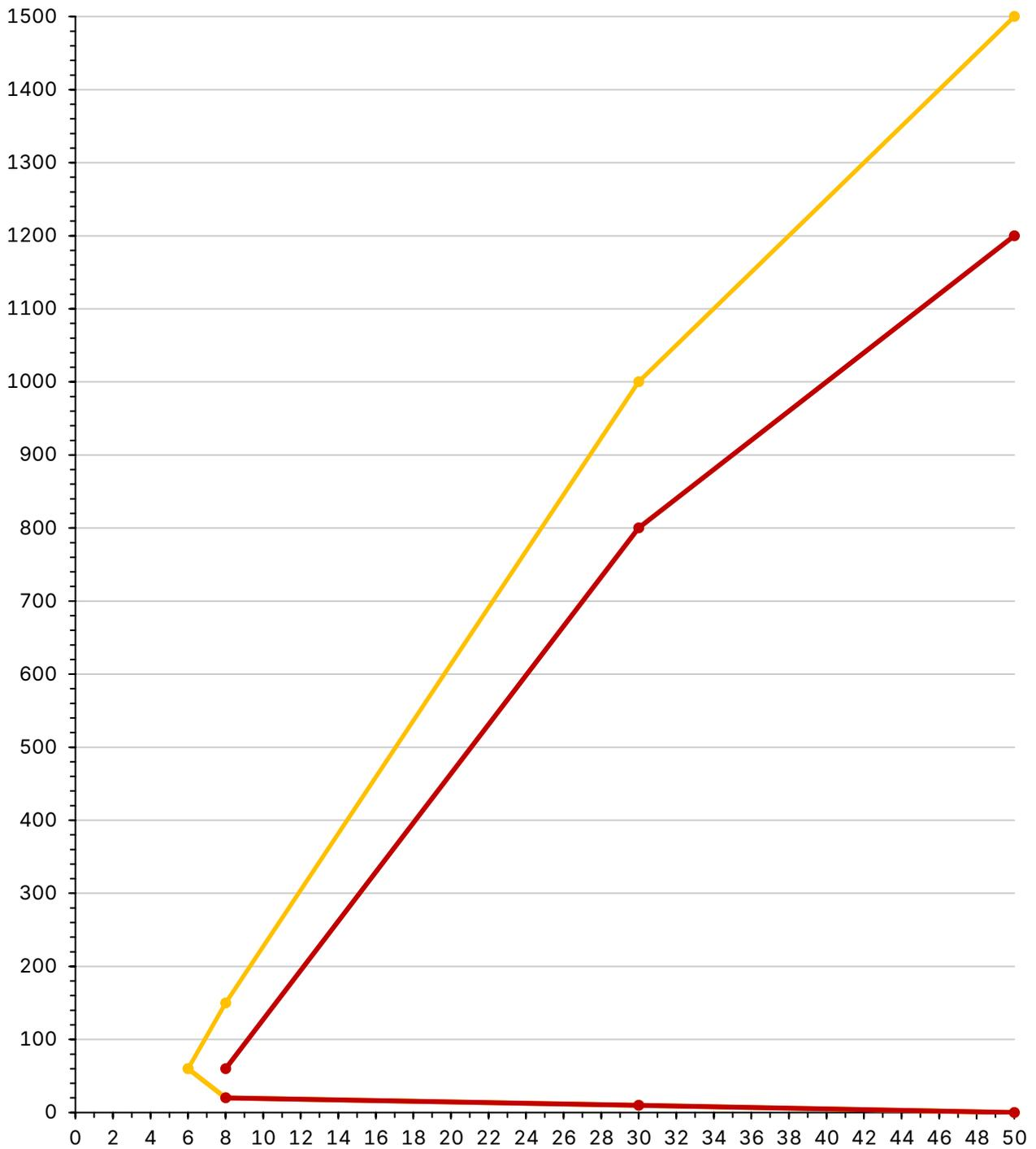
上图中，横轴为下降率（米/秒），纵轴为飞机离地高度（米）。两条黄线之间为「下降率过大」警告的触发范围，两条红线之间为「拉杆」警告的触发范围。
